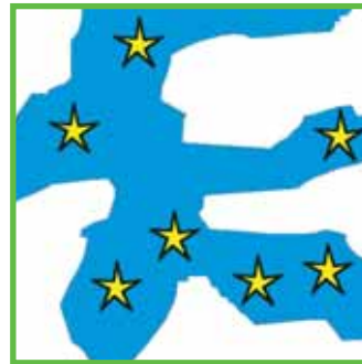
Wassergefüllte Pore mit gelösten Salzen
